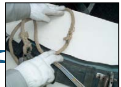
安全帯の点検 ※7
