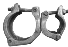
上柱用クランプ NC-82C (3.8kg) 自在型 φ 82.6 × φ 48.6
