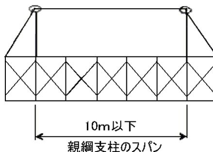
イ 親網支柱を設置した作業床と衝突のおそれのある床面等との垂直距離（H）に応じて使用することのできる親網支柱のスパン（L）は、次式により算出した値以下であること。ただし、Hは3.8 m以上を確保すること。
