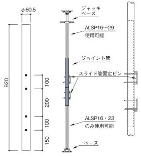
\*水平つなぎは高さ1800mm以内ごとに2ヶ所取付けて下さい。 \*使用最大長は4800mmとします。
