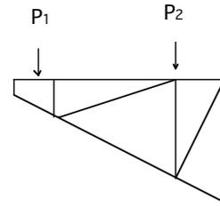
アングルブラケット荷重点1点の許容荷重 = 2.0 t = 19.6kN
